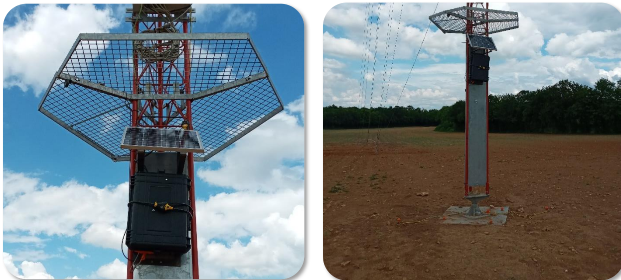
Photo 3 : Dispositif d'enregistrement sur le mât de mesure et environnement immédiat
